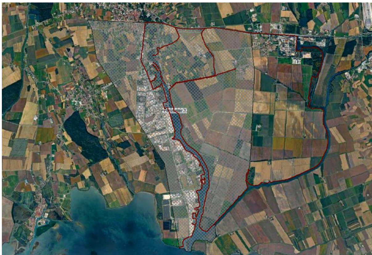
Figura 17 - Breaklines lungo il fiume Corno utilizzate nella presente modellazione idraulica.
