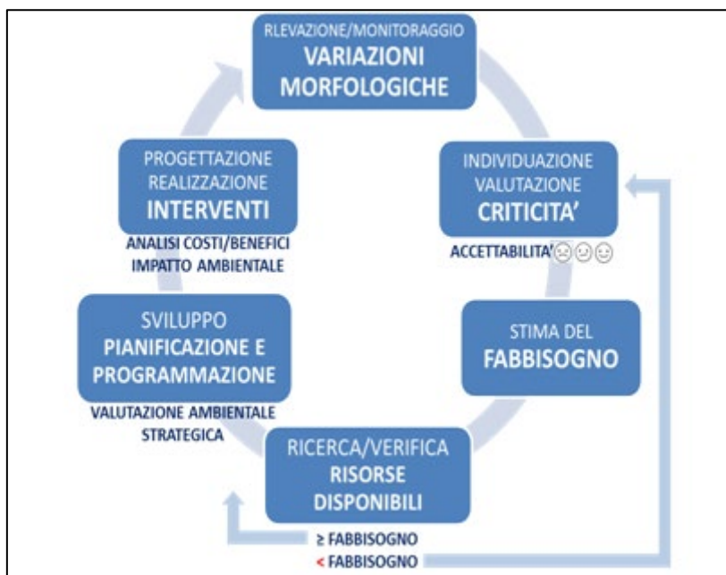
Figura 4-4 Schema per un corretto approccio alla valutazione e gestione dell'erosione costiera
