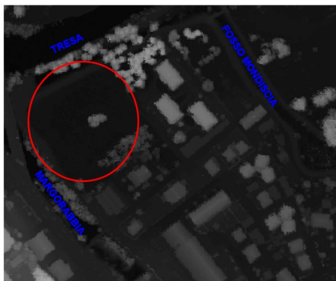
Figura 66. Lidar della zona nei pressi della confluenza del Margorabbia e del fosso Mondiscia nel Tresa. Con colori più scuri le zone caratterizzate da quote inferiori. Si noti la presenza di un'area depressa senza possibilità di scarico (in rosso).
