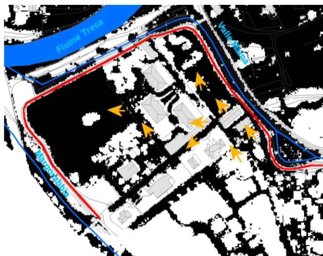
Figura 51. Esempio di aree protette da arginature (in rosso) lungo il Tresa e Margorabbia che tuttavia sono interessate da allagamenti. Sono evidenziate in nero le quote inferiori al livello M (198.122m s.l.m.) e con frecce arancioni i flussi idrici.
