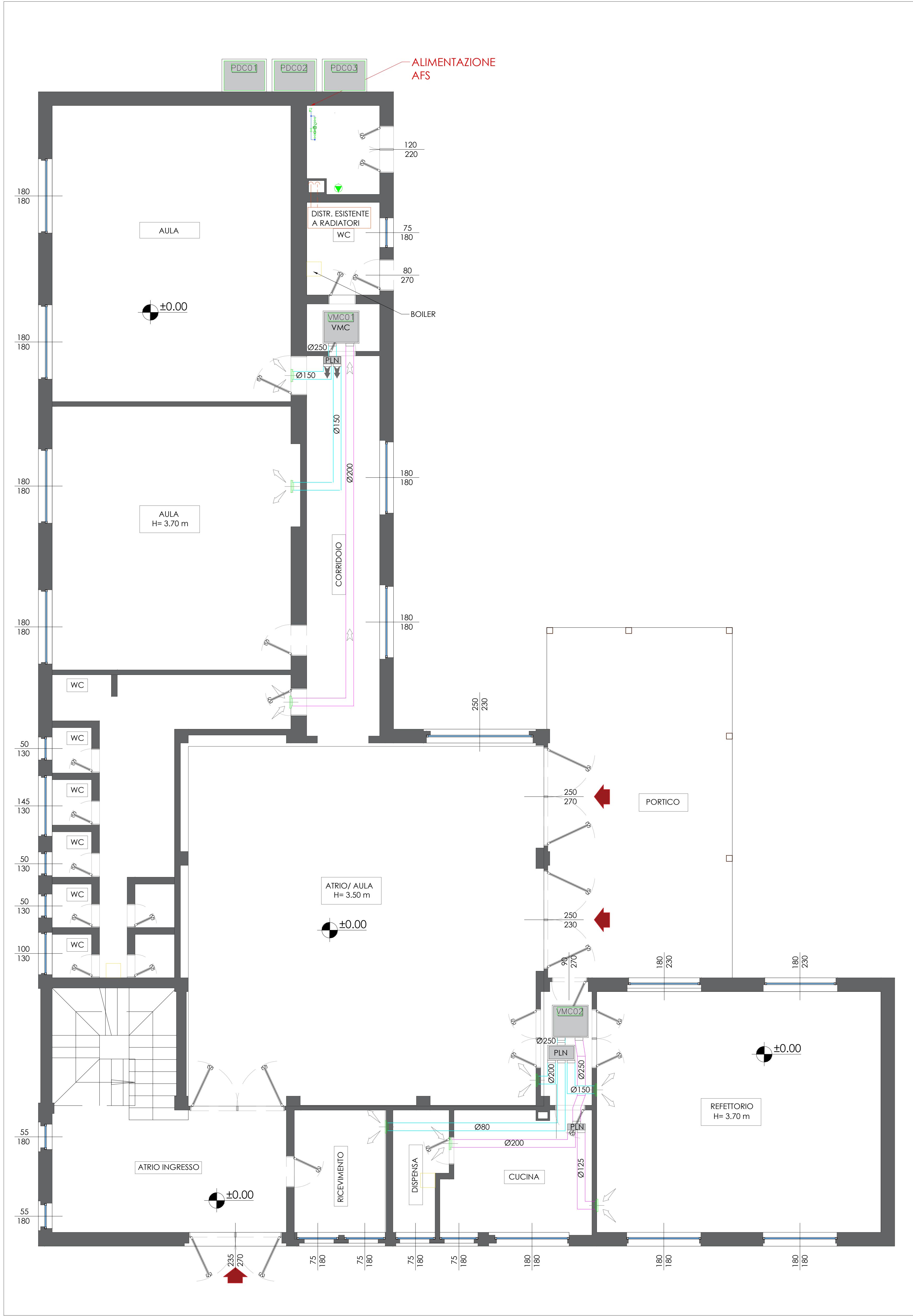
PIANTA PIANO TERRA - VENTILAZIONE MECCANICA CONTROLLATA
