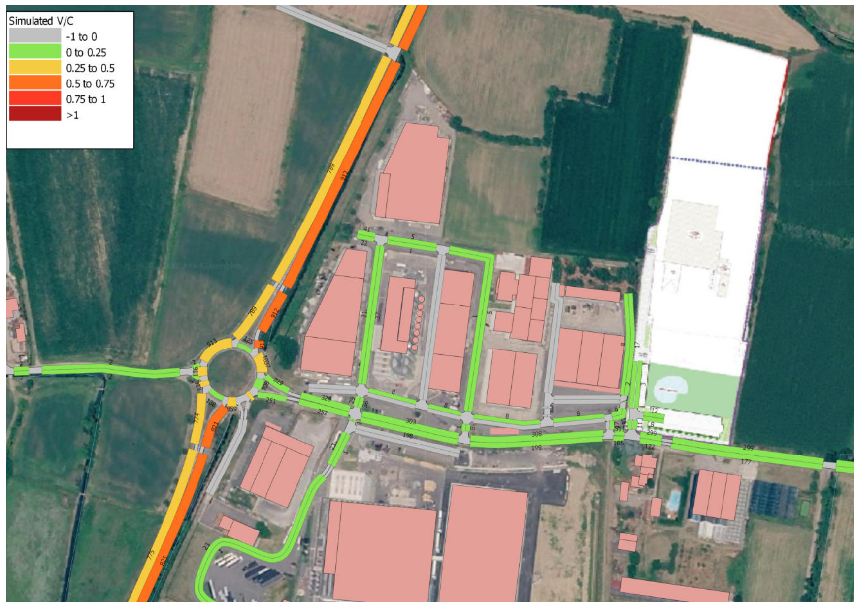
Figura 31 – Flussogramma rete stradale area di studio – scenario di progetto
