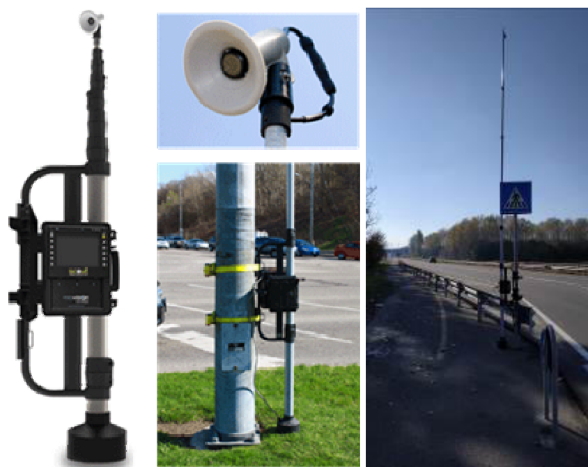
Figura 11 – Strumentazione video con palo telescopico
