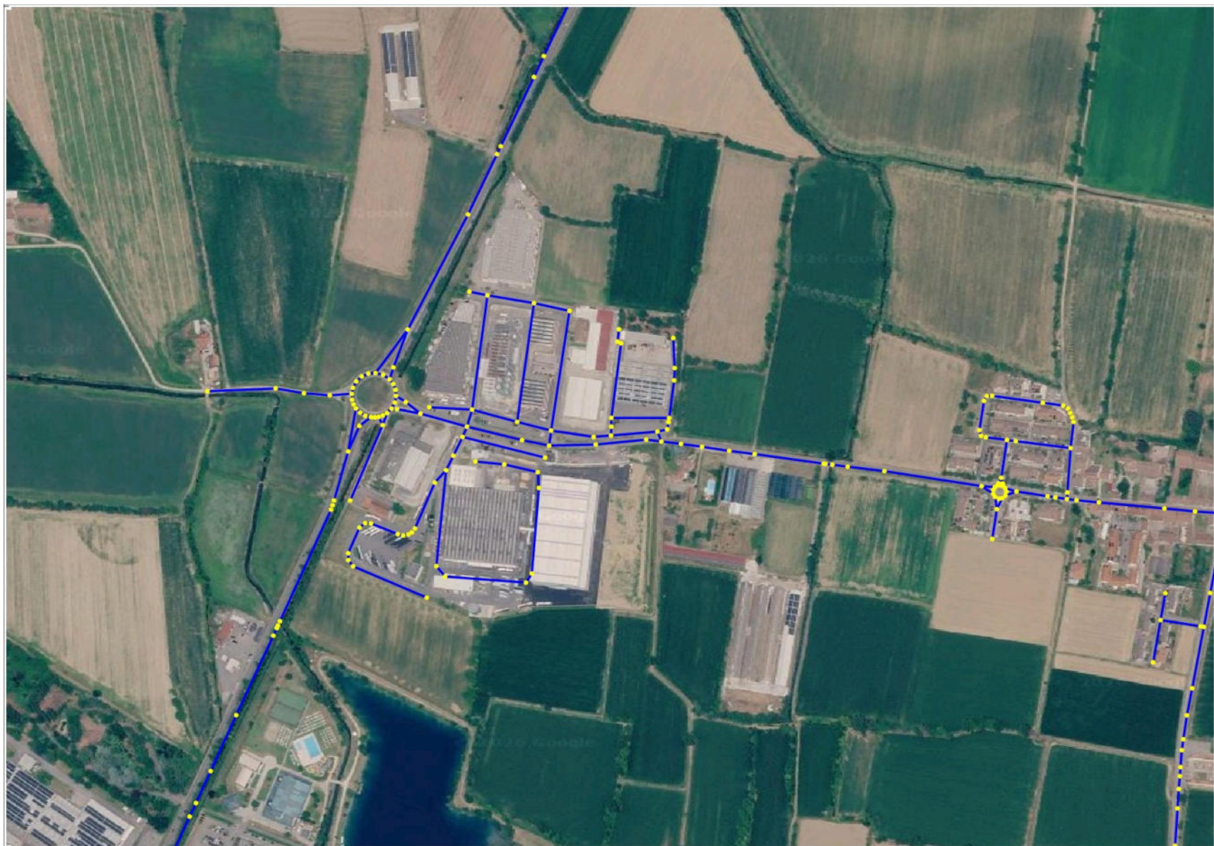
Figura 17 – Estensione del grafo di rete adottato per le successive simulazioni
