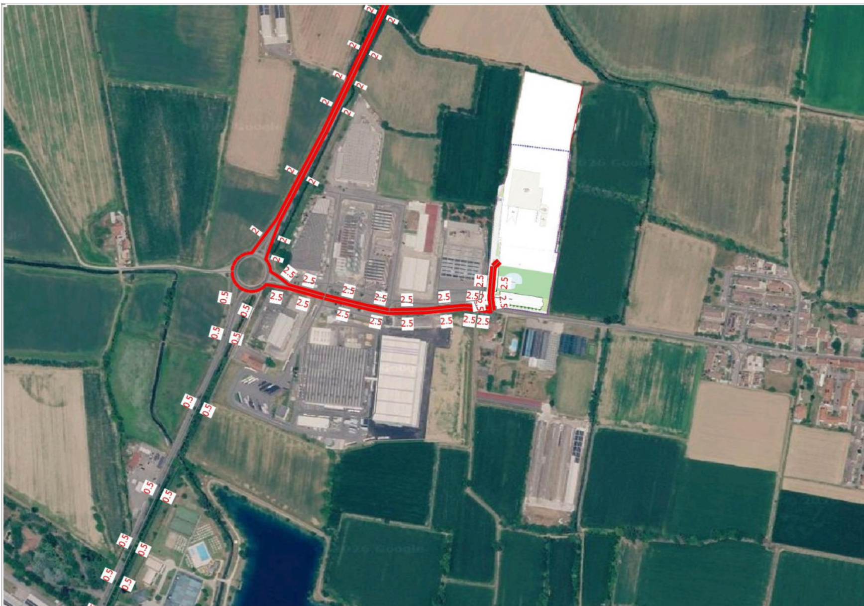
Figura 28 – Flussi aggiuntivi in ingresso all'area di intervento – HPM – mezzi pesanti espressi in Veq/h
