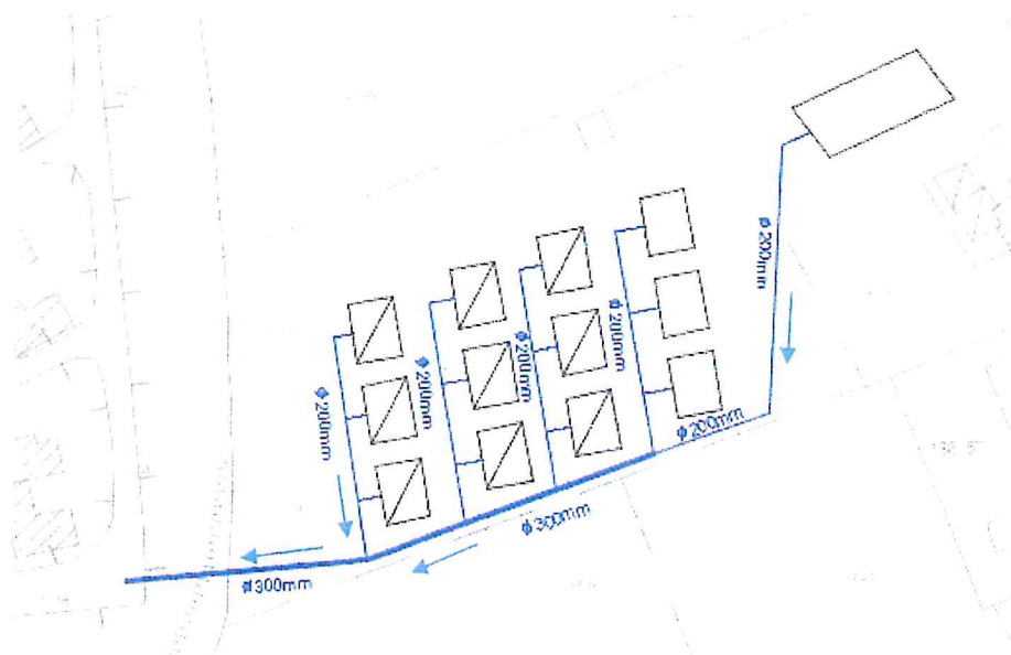
Figura 6. Schema di funzionamento dei reflui civili
