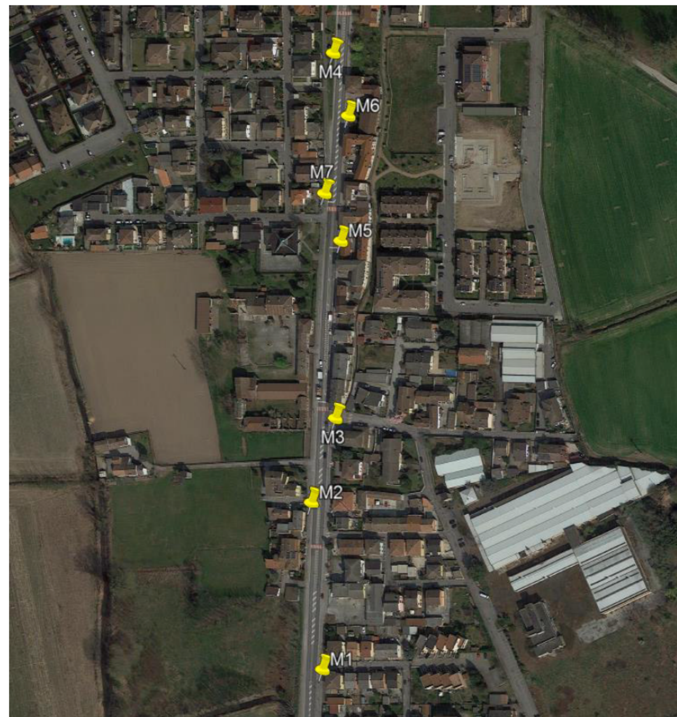
Figura 1: Ubicazione stazioni di misura delle vibrazioni.
