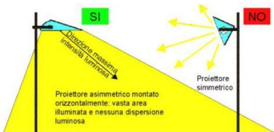
Figura 25 Proiettore installato in modo conforme alla L.R. 17/09
