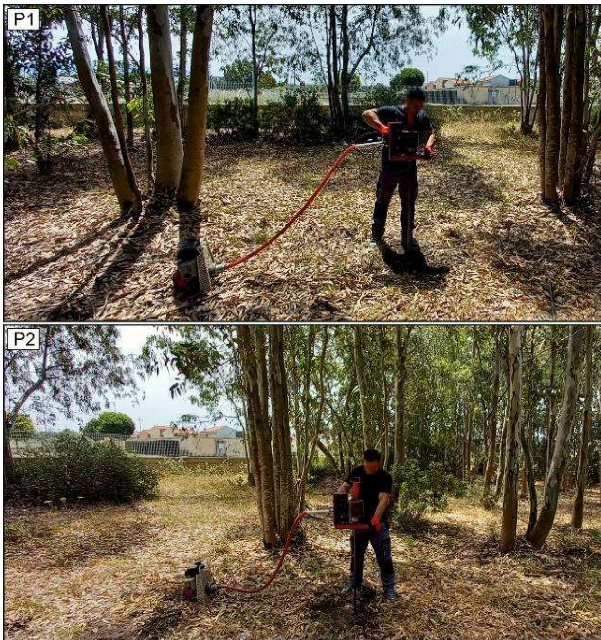
Fig. 14 - Posizionamento delle prove penetrometriche.
