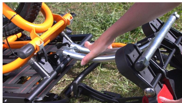
6- posizionare il piede nelle tacche stringendo i due tubi al fine di inserirlo facilmente
