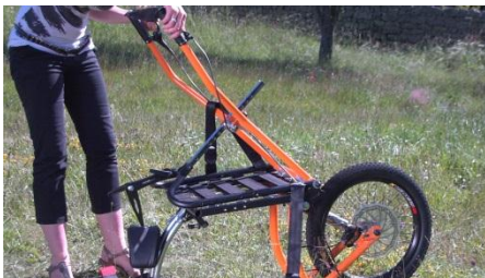
10- Ruotare lo schienale, agendo sulla levetta di regolazione, finché la ruota tocca il terreno
