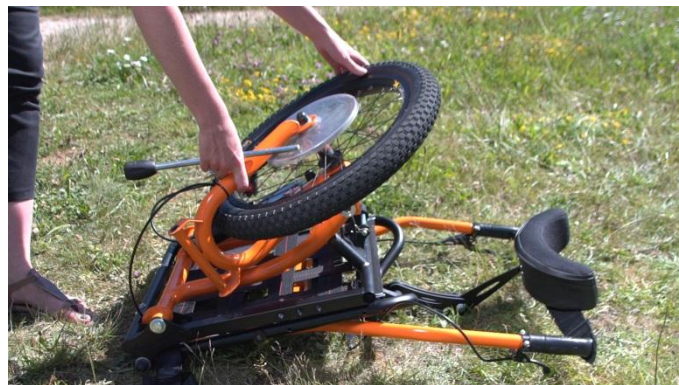
2- Rimuovere il mandrino e la coppia dalla loro collocazione e far girare la ruota
