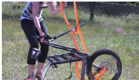
10- Ruotare lo schienale, agendo sulla levetta di regolazione, finché la ruota tocca il terreno
