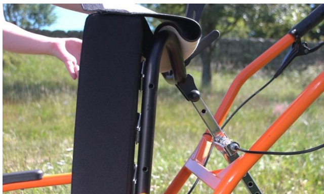
15- Posizionare il cuscino dello schienale passando la fodera in tessuto dietro lo schienale e mantenerlo con la striscia di velcro
