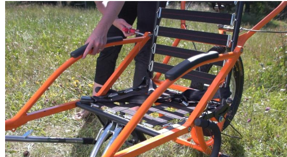
12- Mettere l'altra vite al livello del sedile e stringere bene. Ugualmente sul secondo braccio.
