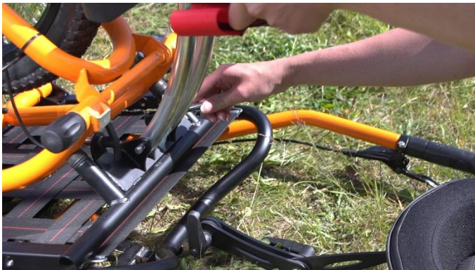
7- Rimettere l'asse nella sua collocazione e rimettere la coppia di sicurezza.
