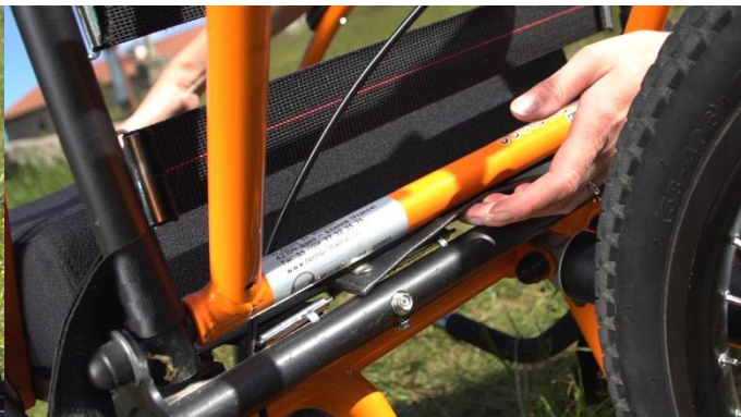
14- Far passare il sistema d'attacco sotto lo schienale e premere sugli automatici a pressione
