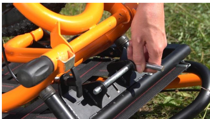
4- Rimuovere la coppia di sicurezza e togliere l'asse
