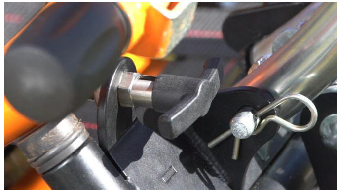
8- Posizionare la maniglietta in posizione orizzontale
