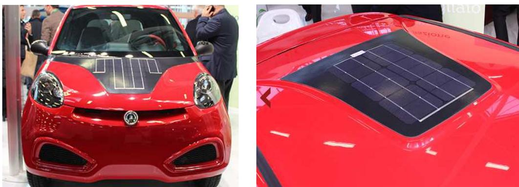
Fig. 6.4 – Foto della i.Car0. particolare anteriore e del tetto munito di pannelli fotovoltaici.
