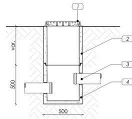
PROGETTO - Particolare pozzetto d'ispezione
