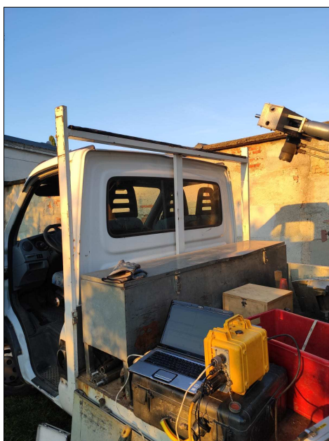
Acquisizione del segnale sismico mediante sismografo Geometrics Modello Geode 3-1000
