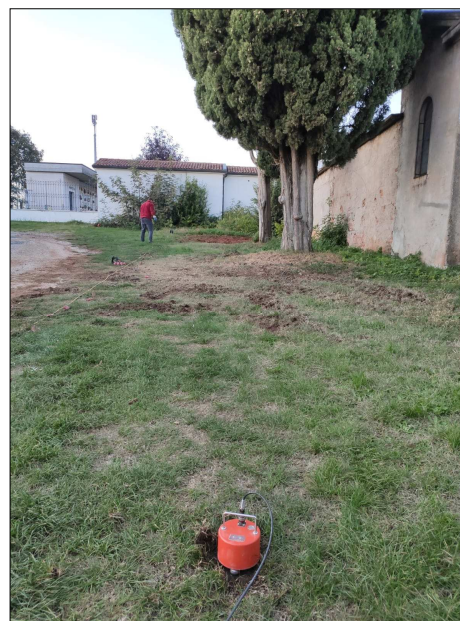
Acquisizione del microtremore sismico ambientale mediante tecnica H.V.S.R.
